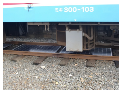
図 8.3 A T S 装置通過テスト
