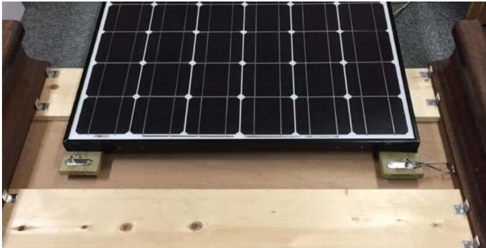
図 6.5 木材絶縁方法 取付テスト
