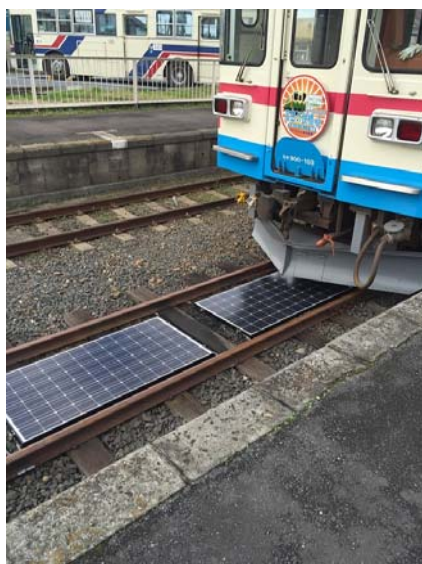
図 8.1 A T S 装置通過テスト
